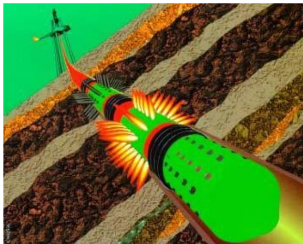
Imagem 10 - Ilustração do processo de canhoneio
