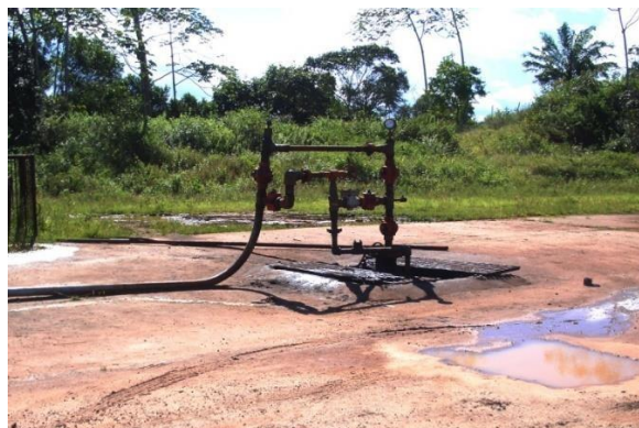
Imagem 9 - Poço equipado com Bomba Eletro Submersível
